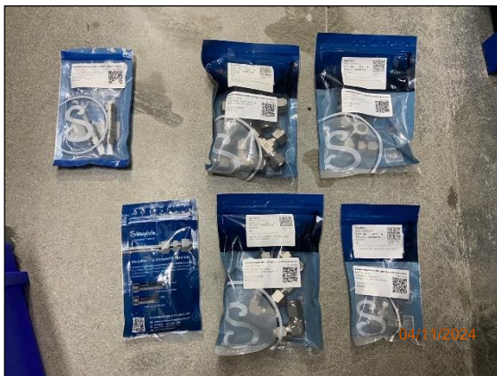
รูปที่ 2.4 ตัวอย่างอะไหล่สำรอง สำหรับการซ่อมบำรุงอุปกรณ์ต่างๆ ที่เกี่ยวข้องกับระบบ CEMS
